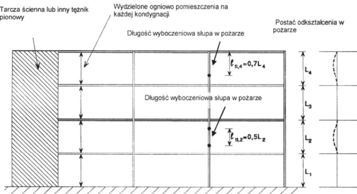
Rysunek 4.1: Długości wyboczeń słupów l_{fi} w ramach stężonych
