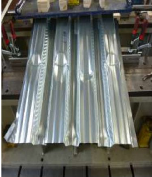
Uszkodzenia profilu blachy na podporze skrajnej
